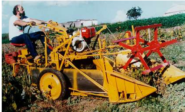
Figura 14. Colhedora de pequeno porte para plantas inteiras, parcelas experimentais e pequenas lavouras.
