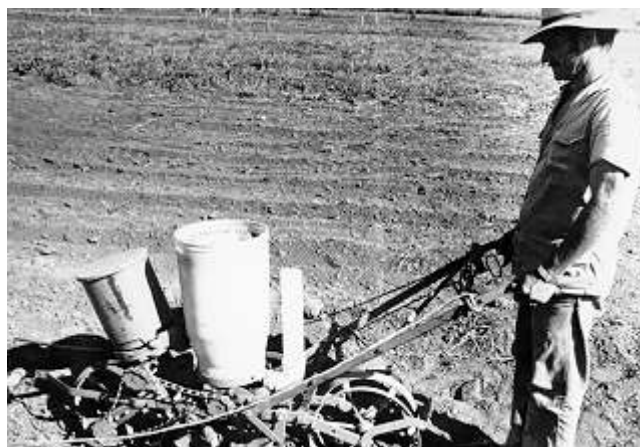
Figura 4 - Dispositivo para aplicação de inseticidas granulados acoplado a plantadeira animal.
