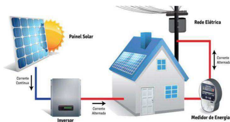
Figura 8 – Sistema de geração fotovoltaico ( on-grid ).
