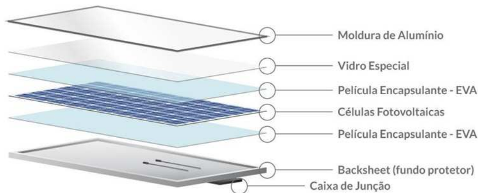
Figura 1: Partes de um módulo fotovoltaico.
