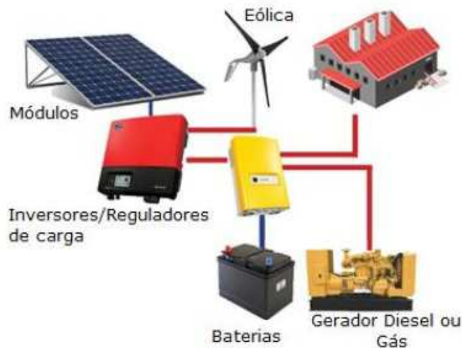
Figura 8: Representação de um sistema híbrido.
