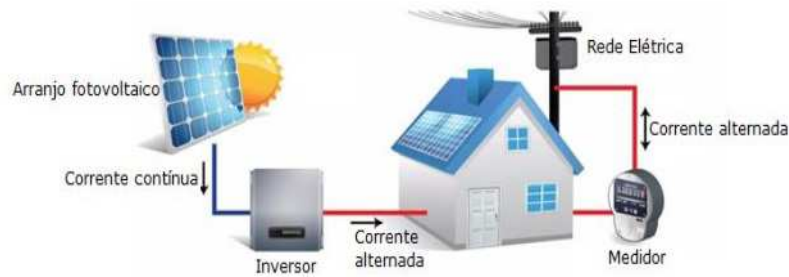
Figura 6: Representação de um Sistema Ligado à Rede.
