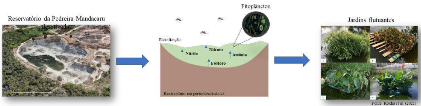
Figura 36: Esquema representando a utilização de FTWs para biorremediação do reservatório da pedra Mandacaru.
