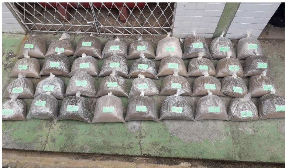
Figura 22 - Amostras deformadas de solos.
