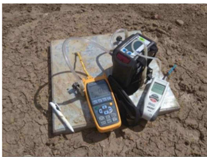
Figura 6 - Placa de fluxo estática.
