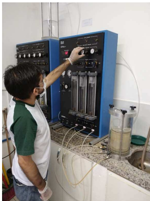
Figura 28 - Sistema de Permeabilidade Triflex-2.
