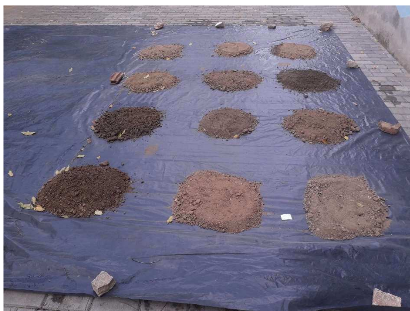
Figura 23 - Homogeneização das amostras de solos.
