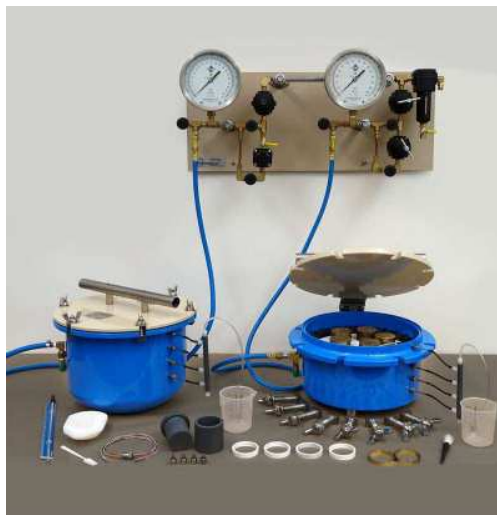
Figura 10 - Câmara de Pressão (Richards).
