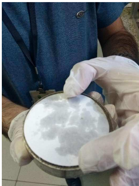
Figura 34 - Posicionamento dos papéis filtro.
