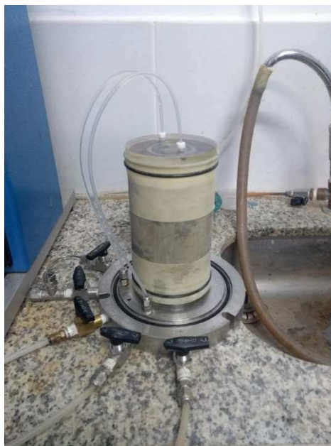
Figura 30 - Posicionamento do corpo de prova de solo na base da câmara.
