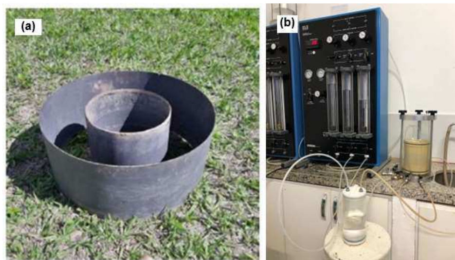
Figura 5 - Ensaios de permeabilidade do solo à água: (a) infiltrômetro de anel; (b) permeâmetro de parede flexível.
