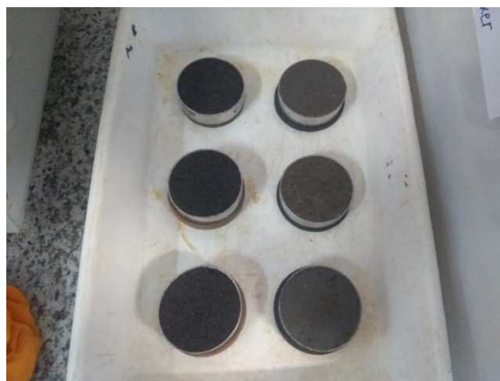
Figura 33 - Processo de saturação das amostras.
