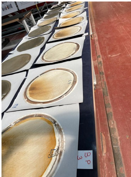
Figura 13 - Membrana interna de um eletrolizador com marcas alaranjadas de ferrugem.
