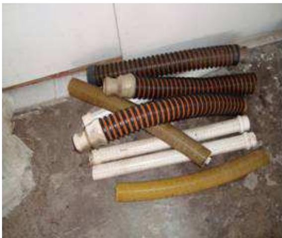
**Figura 6** Tubos Drenantes (Drenoflex, PVC liso para esgoto e Kanonet) antes de se colocar o envoltório.
