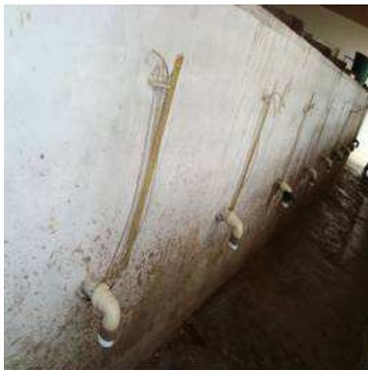
**Figura 4** Vista lateral do sistema com os piezômetros acoplados
