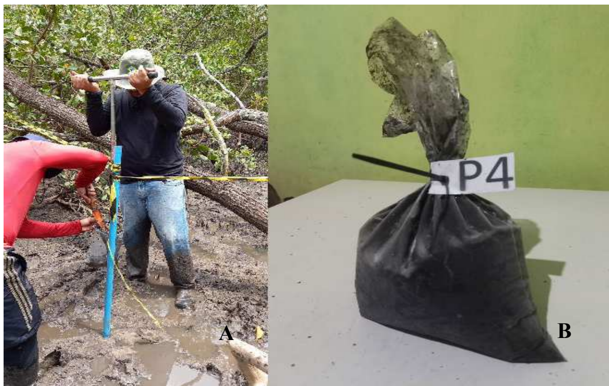
Figura 15 – Coleta do solo nas parcelas. Utilização do trado para perfuração do solo (A) e acondicionamento do solo em saco plástico (B).
