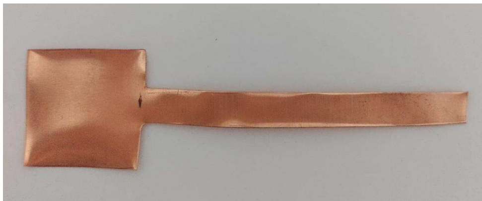
Figura 11 - Eletrodo de trabalho antes do revestimento
