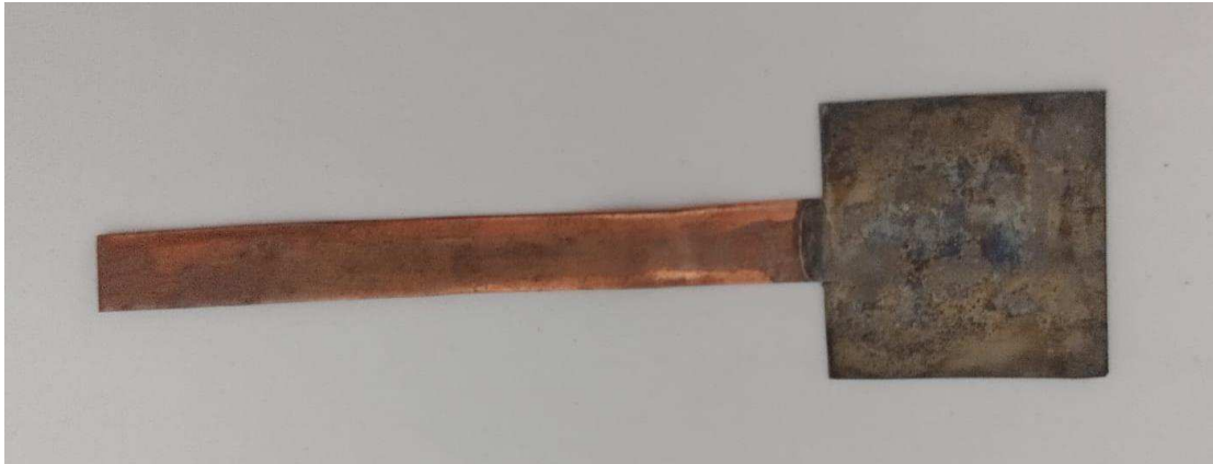
Figura 12: Eletrodo de trabalho após o revestimento
