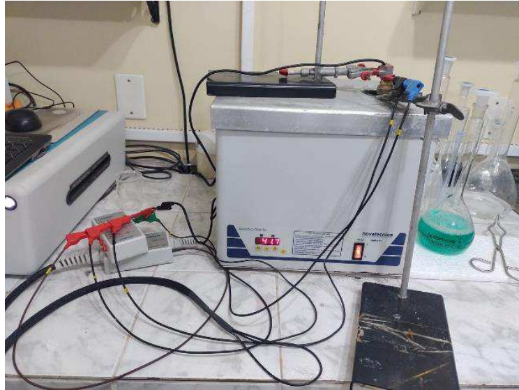
Figura 13 - Processo de Eletrodeposição Montado para obtenção da Liga de Ni-Co
