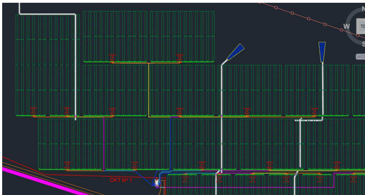
Figura 14 – Traçado geral de baixa tensão
