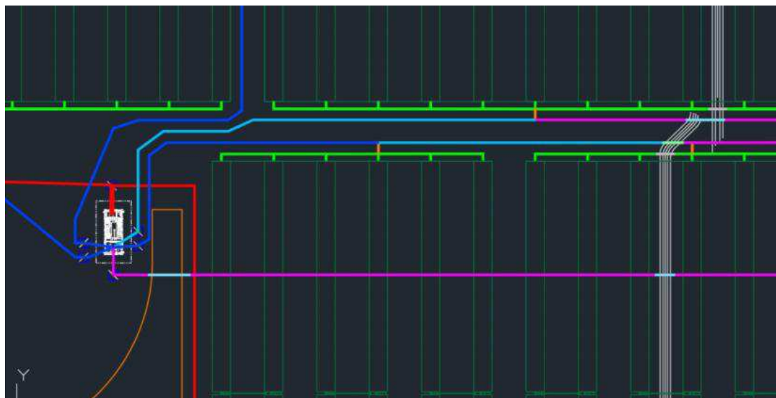
Figura 15 – Detalhe da chegada dos cabos no Eletrocentro
