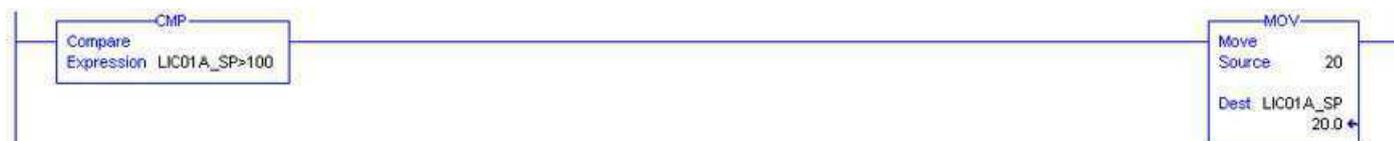
montar o conjunto de dados do tipo LIC01A, responsável pela ação de controle (dados do controlador PID, PV e SP). Na linha seguinte, é utilizado o bloco do controlador PID com os ajustes apropriados. O trecho do LADDER, é apresentado na Figura 18.
