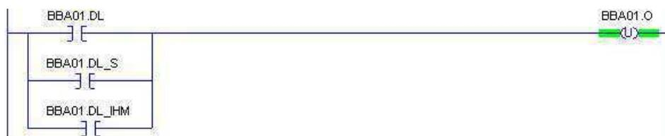
Figura 7 – Acionamento dos data types responsáveis por ligar e desligar o inversor.
