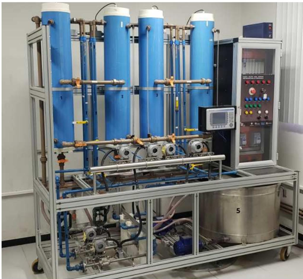
O sistema ainda possui duas válvulas elétricas, que estão conectadas entre os tanques e o reservatório, e são utilizadas para o esvaziamento dos tanques no sistema de controle.
