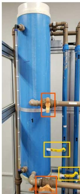
Figura 4 – Válvulas elétricas usadas na planta.
