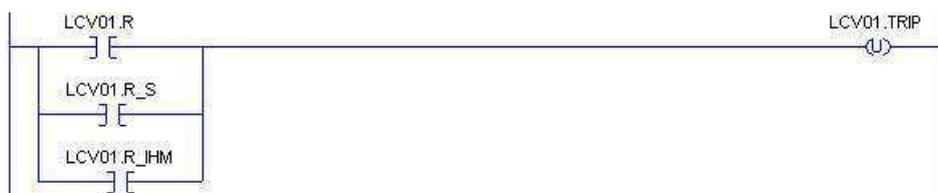
Como apresentado na Figura 11, este mesmo contato é utilizado em série com a habilitação da válvula (LCV0x.EN) e com os comandos de abertura total da válvula (LCV0x.CMOP\_S, LCV0x.CMOP\_I e
