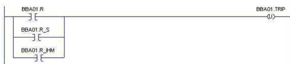
Na linha seguinte e Figura 5, BBA0x.TRIP é conectado em série com BBA0x.EN (habilitação da bomba) e BBA0x.LG (função de ligar a bomba – “botoeira liga”) para ativar a saída BBA0x.O, uma saída física digital do tipo LATCH (set), que aciona o inversor.
