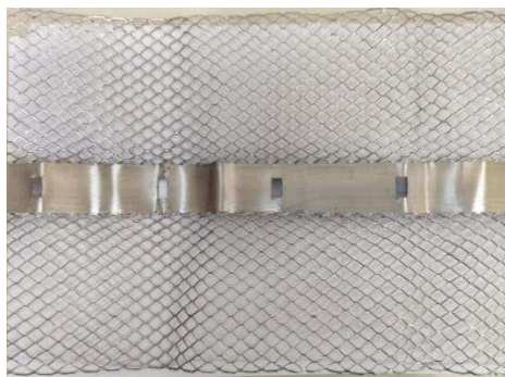
Figura 9 – Fita de grade expandida usada para produção de placas de baterias automotivas chumbo-ácido.
