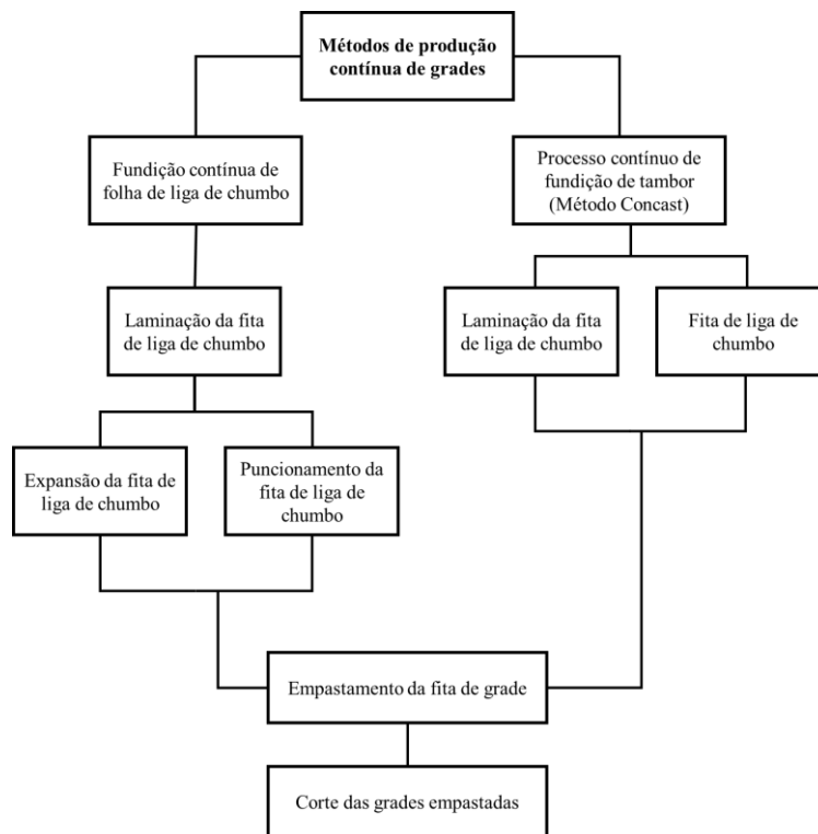
Figura 8 – Diagrama dos métodos mais comuns para produção contínua de grades para baterias chumbo-ácido SLI.
