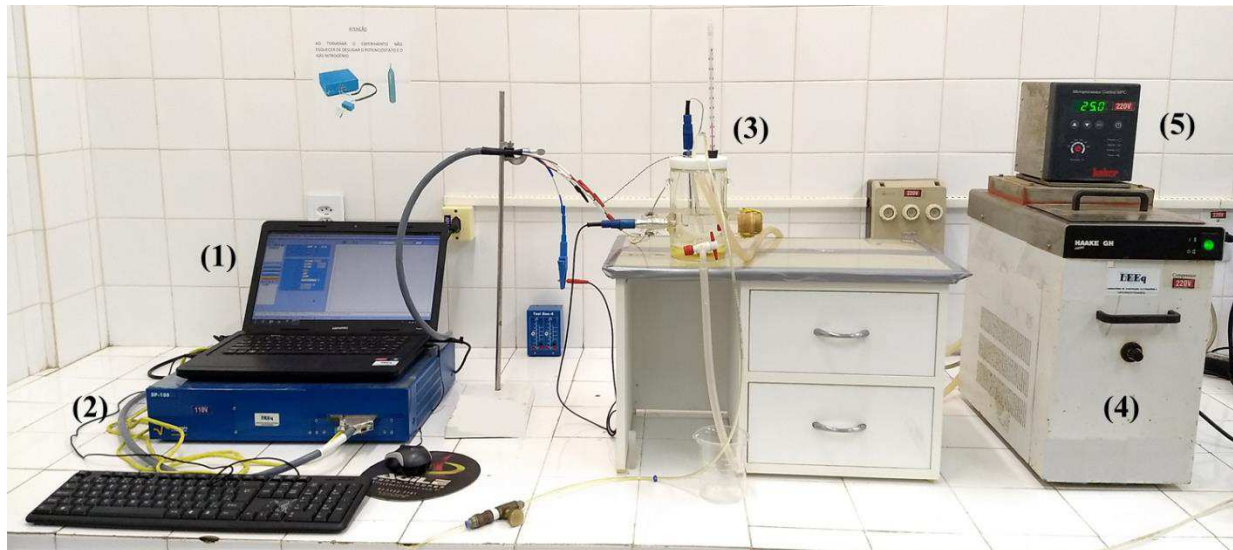
Figura 23 – Sistema para realização dos ensaios eletroquímicos sendo composto por notebook (1), potenciostato (2), célula eletroquímica (3), compressor refrigerador (4) e controlador microprocessador (5).
