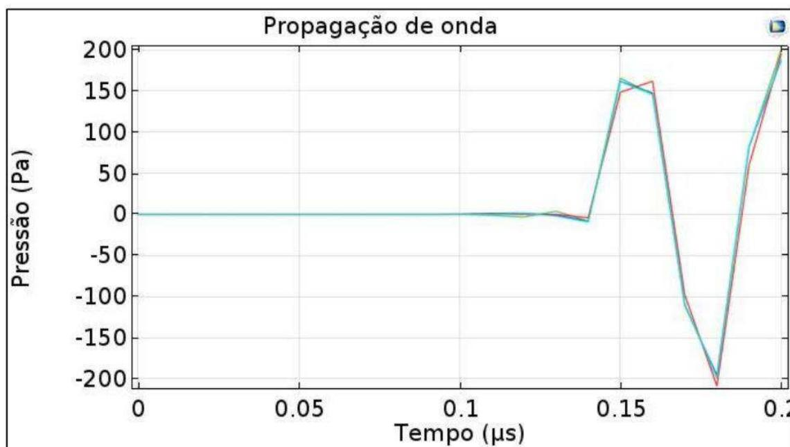
**Figura 25** - Variação de pressão gerada pela passagem da onda simulada no COMSOL Multiphysics (Apolinário, 2016).
