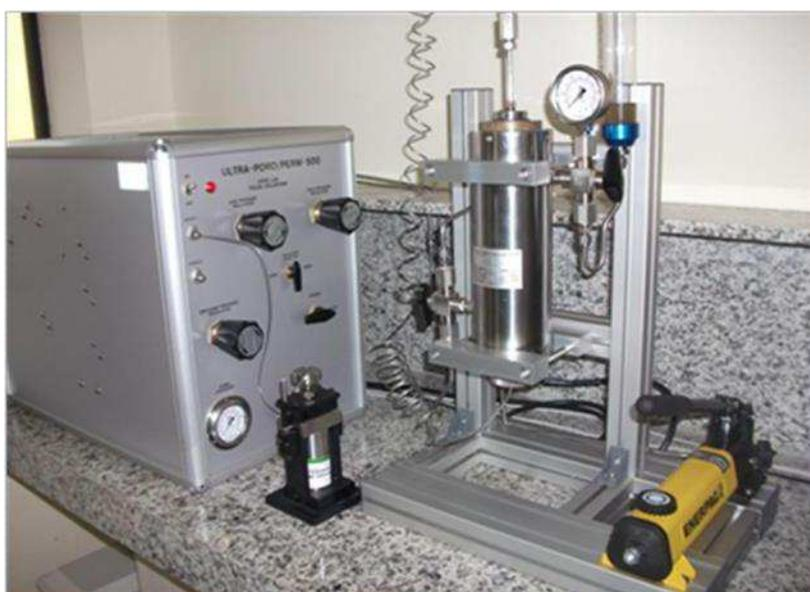
**Figura 69** - Equipamento Ultraporperm 500® utilizado na medição da porosidade e densidade de grãos e total. Fonte: Batista (2016).
