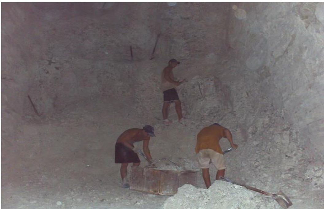
Figura 12 – Operação de extração de caulim por pequenos mineradores
