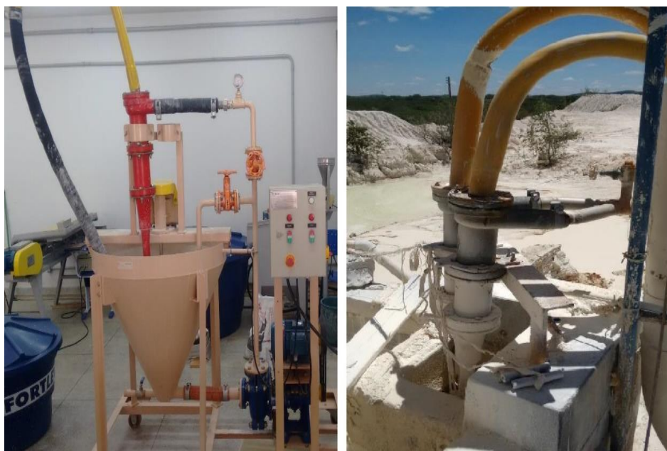
Figura 43 – Ensaios de bancada com hidrociclones
