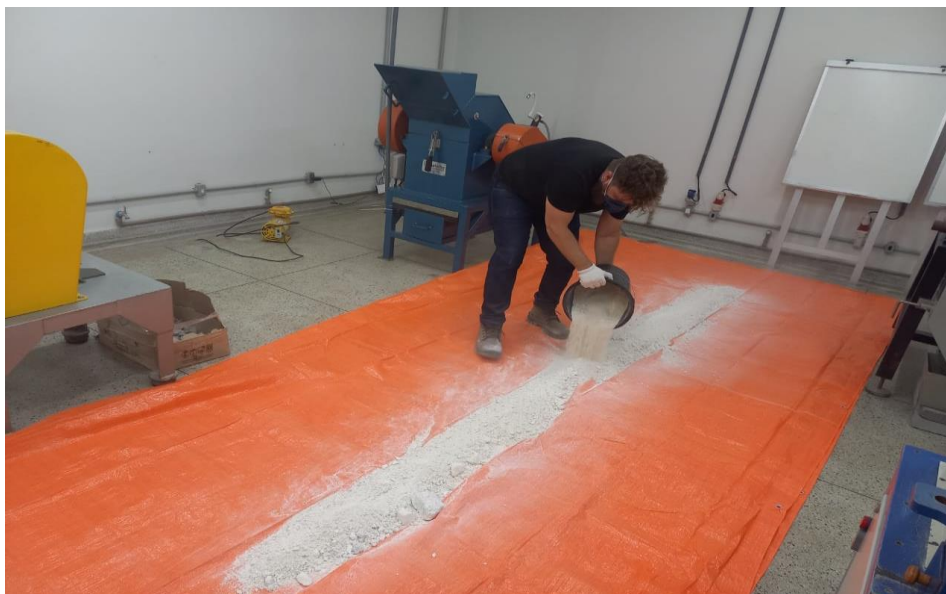
Figura 39 – Preparação da amostra de resíduos de caulim no laboratório do IFPB
