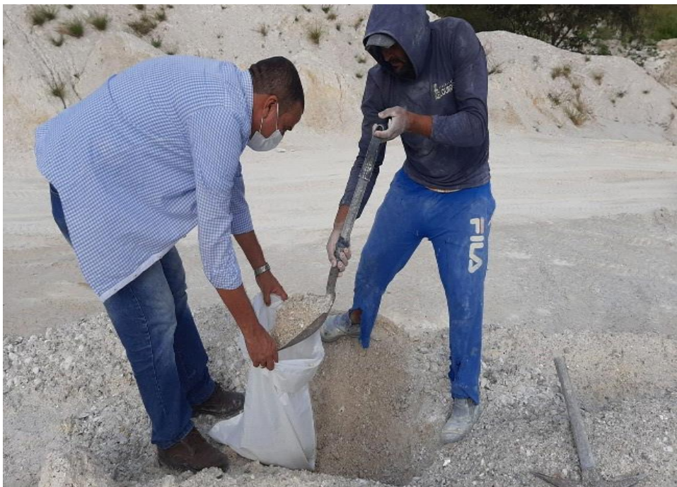
Figura 18 – Medições e coleta da amostra bruta de resíduos de caulim
