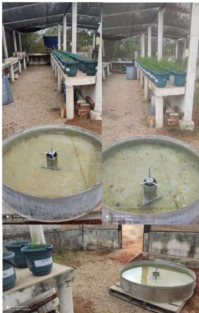
Figura 3. Tanque Classe A instalado dentro da casa de vegetação
