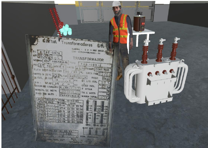
Figura 21. Captura de tela do processo de inspeção visual do transformador.
