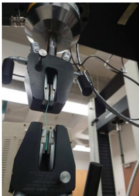
Figura 13 - Teste mecânico de swabs com um Instron 4206
