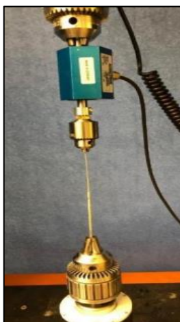
Figura 21 - Demonstração do teste de torção
