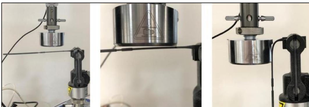
Figura 16 - Imagens do cotonete antes durante e após o ensaio de flexão.
