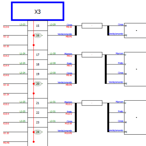
Figura 16 – Bornes do painel direito da saída de alimentação dos motores (continuação).
