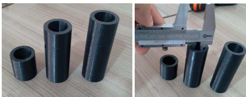
Figura 10 – Teste de impressão Luva. a) testes impressos, b) avaliação de medidas.
