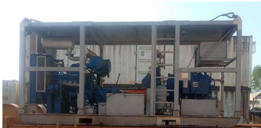
Figura 14 – Unidade de bombeio offshore montada sobre skid.
