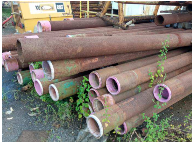
Figura 3 – Colunas de Revestimento
