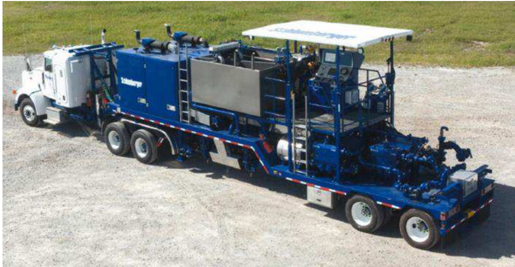
Figura 5 – Unidade de Cimentação CPF-377
