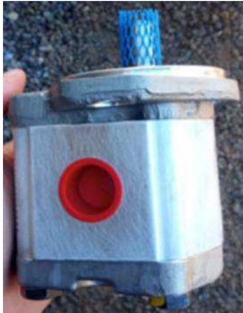
Figura 23 – Bomba de engrenagens.
