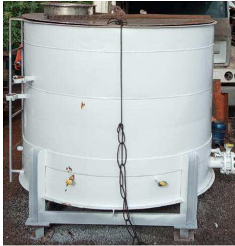
Figura 32 - Silo de Cimento
