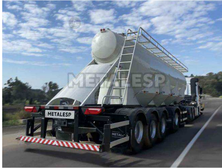
Figura 7 – Caminhão transportador de cimento em pó, com reboque do tipo reservatório.
