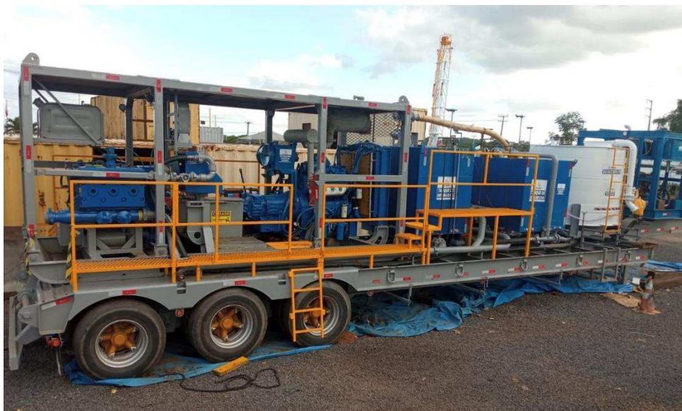
Figura 34 - Unidade de Cimentação UC-01 Finalizada
