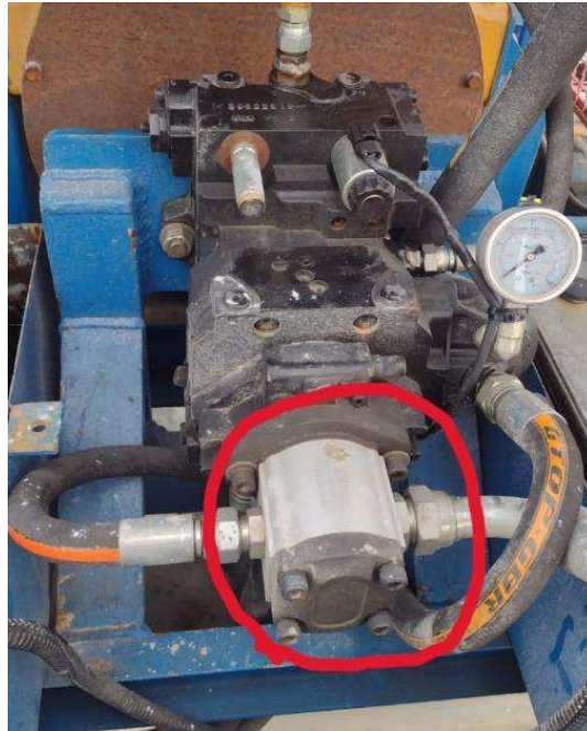
Figura 22 - Bombas hidráulicas já anexadas pelo slot de expansão
