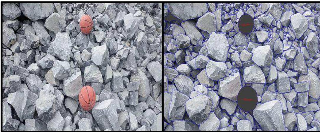
Figura 9 Fragmentos com esferas antes e depois de analisadas no software WipFrag.
