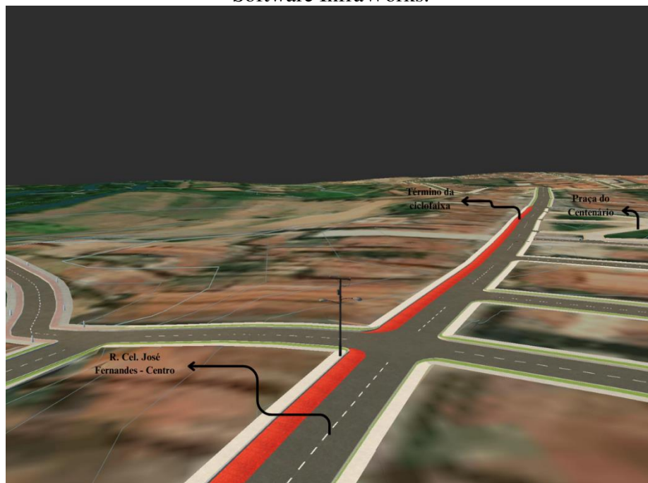
Figura 42 - Proposta de traçado de rota de ciclofaixa, na Rua Coronel José Fernandes no Software InfraWorks.
