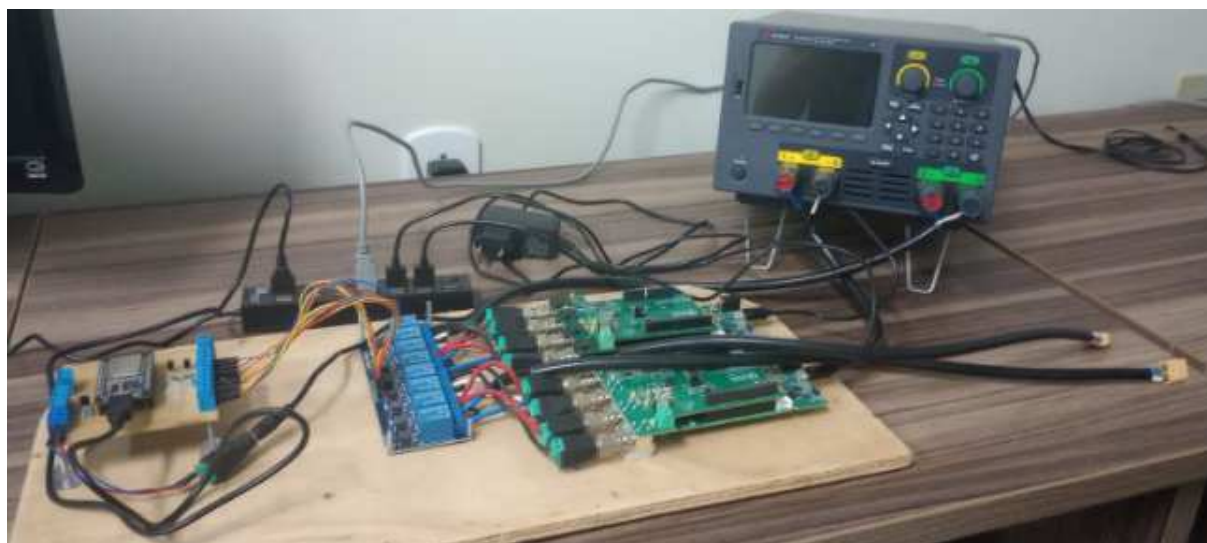
Figura 25 – Plataforma de caracterização de baterias.
