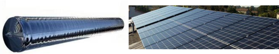
Figura 1: Silício monocristalino e o produto final
