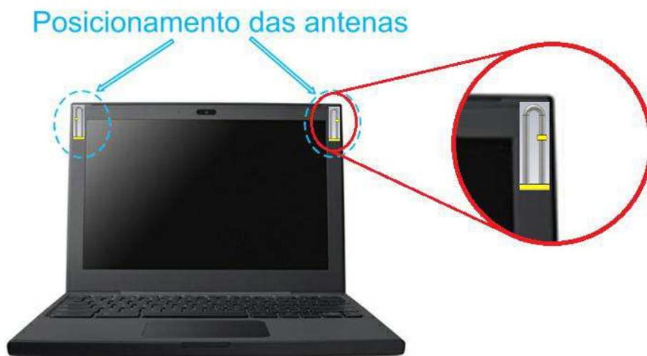
**Figura 5. 8 – Exemplo de instalação da antena MIWA em computador portátil.**
