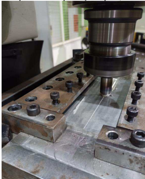
Figura 22: Figura esquematizando a penetração do pino (momento da soldagem).
