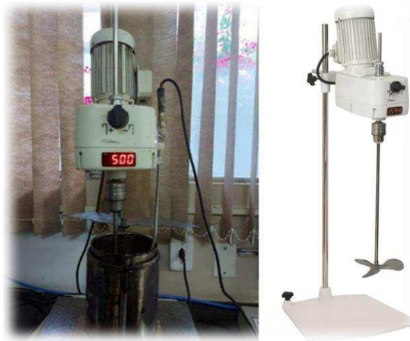
Figura 24 – Agitador mecânico utilizado para realização da modificação dos ligantes
