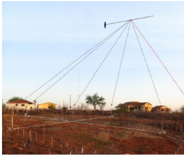
Figura 4.1: Radar meteórico SKiYMET. Fonte: EGITO et al. 2023 [11].
