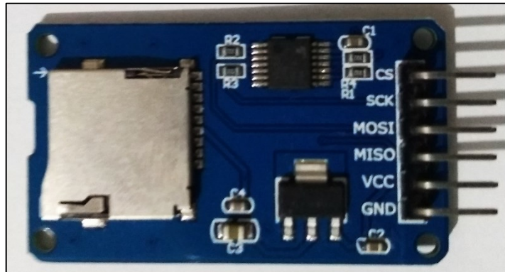
Figura 27. Módulo Leitor Micro SD Card para Arduino. Fonte: Andrade (2021).
