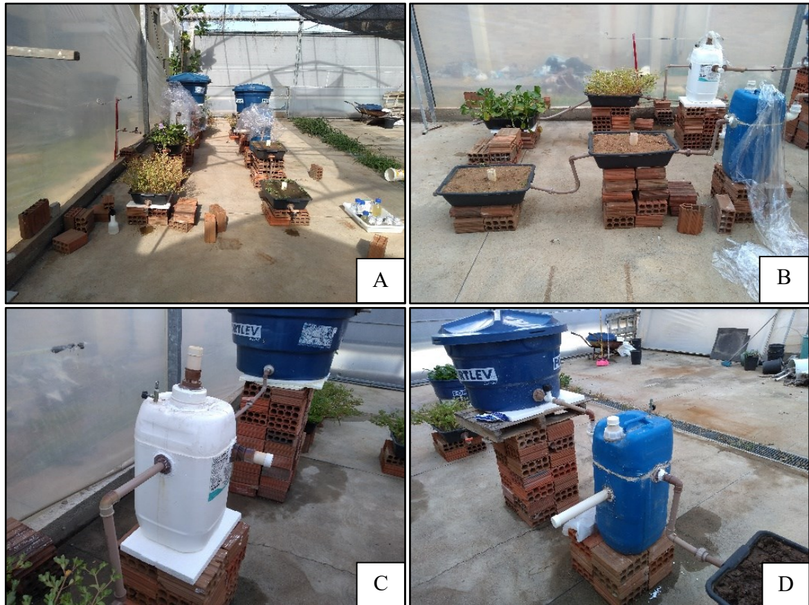
Figura 16. Vista frontal dos SACs. B. Vista lateral dos SACs. C. Biodigestor do SAC com vegetação. D. Biodigestor do SAC sem vegetação. Fonte: Andrade (2021).
