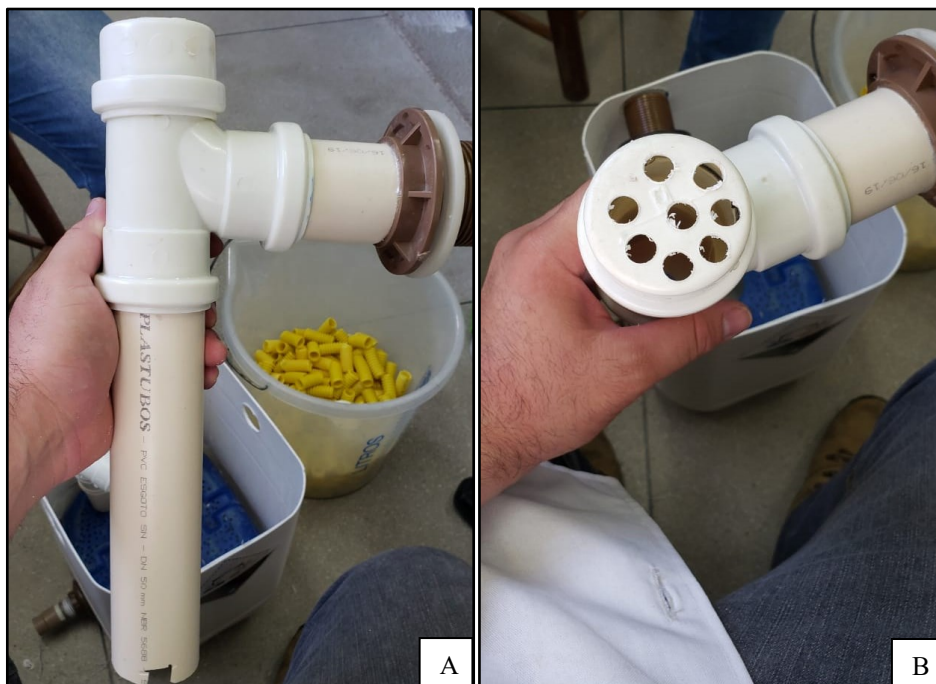
Figura 12. A. Tubulações para entrada do efluente e saída do lodo. B. Destaque para orifícios utilizados para circulação do ar. Fonte: Andrade (2021).
