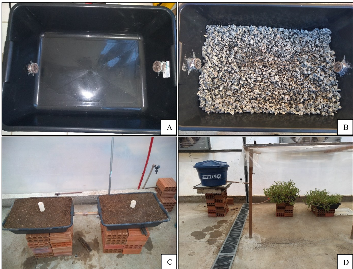
Figura 10. A. Recipiente de PVC usado no SAC. B. Inserção da brita comercial n. 0. C. Inserção do substrato e dos pontos de verificação do nível hídrico. D. Controle da vazão hídrica no SAC. Fonte: Andrade (2021).
