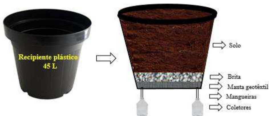
Figura 8. Ilustração da preparação dos lisímetros de drenagem para o preenchimento com solo.
