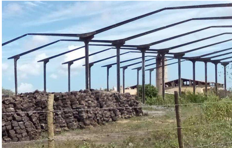
Figura 3 – Secagem natural da diatomita para perda de parte da matéria orgânica.
