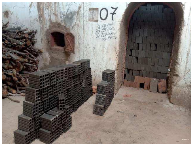
Figura 13 – Forno industrial para queima de tijolos cerâmicos.
