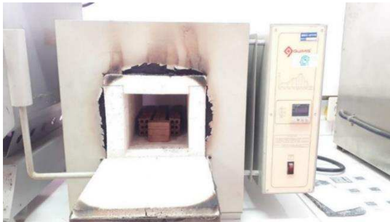
Figura 22 – Forno usado na queima.
