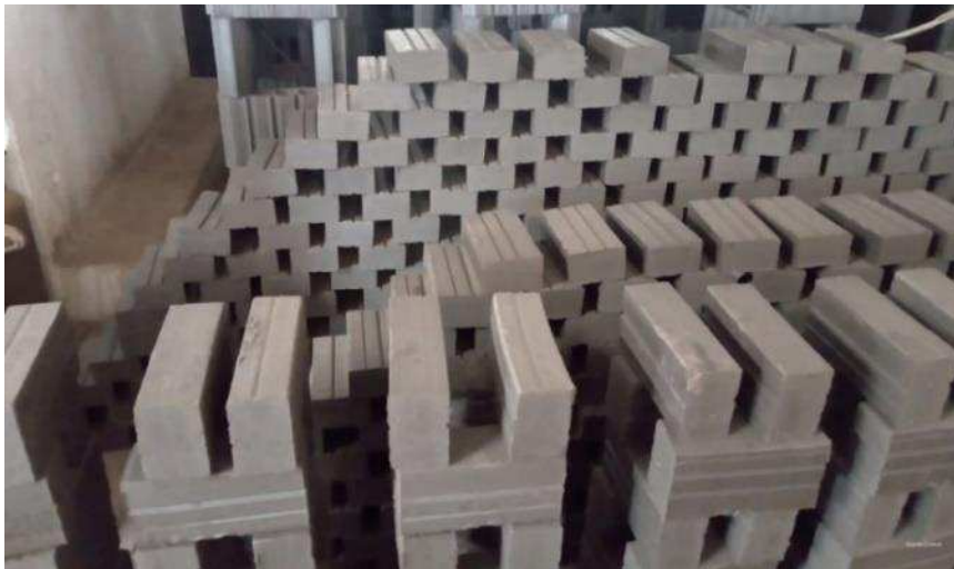
Figura 6 – Tijolos maciços crus (não queimados).
