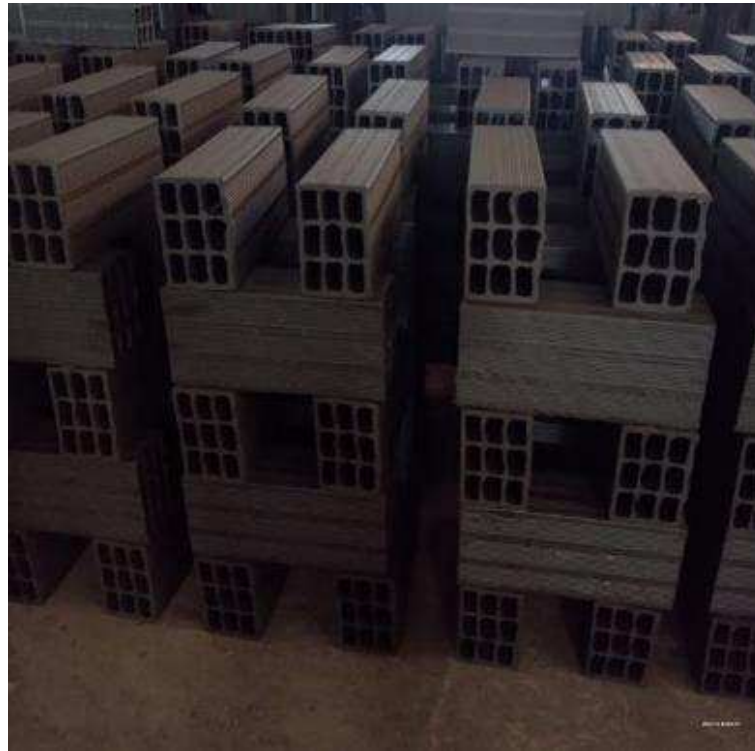
Figura 7 – Tijolos de 9 furos.
