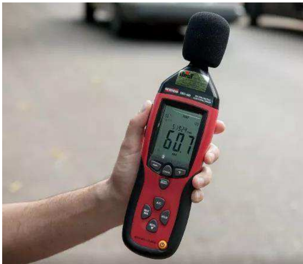
Figura 4 - Equipamento para aferição da intensidade sonora.
