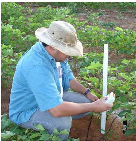
**Figura 3.7:** Coleta de dados de umidade de solo com a sonda PR2
