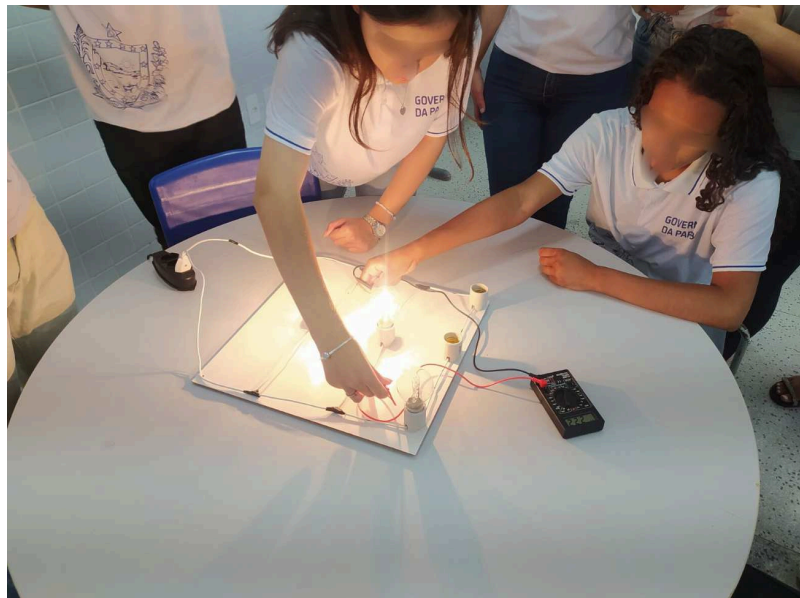
Figura 4: Alunos realizando a medição da tensão do Circuito Elétrico Paralelo.
