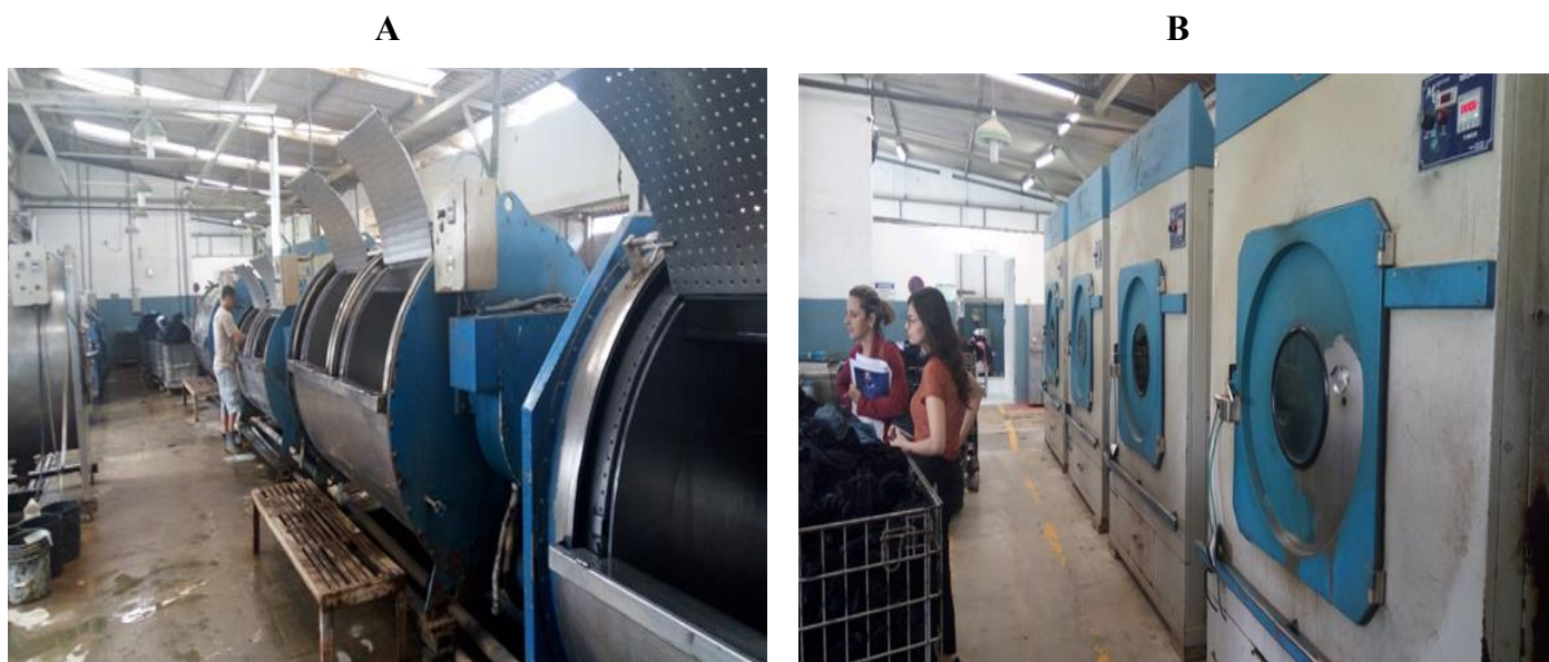
Figura 4- Maquinam utilizadas para fazer a lavagem (A) e centrifugação (B) dos jeans nas industriais/lavanderias têxteis. Retirada pela autora (2018).
