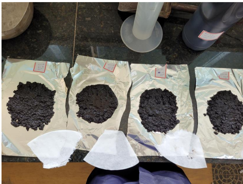
Figura 13: Ensaio de tempo de mistura no MRAF.
