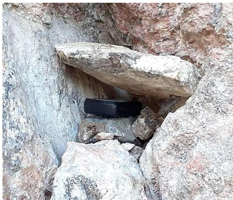
Figura 41- Adaptação do abrigo para leitura do ^{222}\text{Rn} em Garimpos
