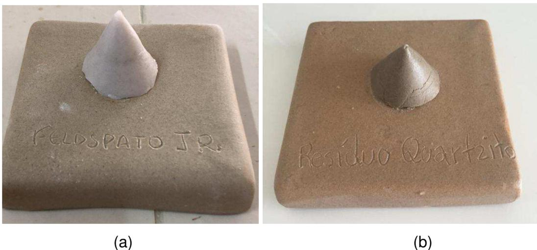
Figura 10 - Cones de fusibilidade do feldspato (a) e do resíduo de quartzito (b).
