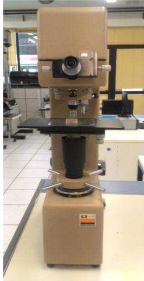
Figura 7 - Durômetro utilizado no ensaio de microdureza.
