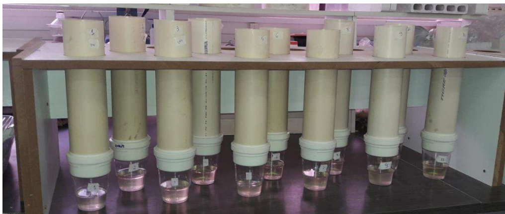
Figura 12 – Colunas de solo para o teste de lixiviação da ureia
