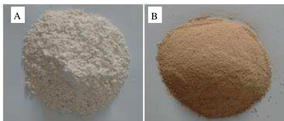
Figura 4.1: Amido de pitomba obtido em solução de metabissulfito de sódio (A) e em solução de hidróxido de sódio (B).
