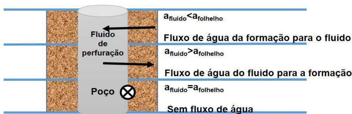
Figura 4 - Transporte de água através de uma membrana semipermeável perfeita na interface folhelho-fluido de perfuração (Adaptado de Hawkes et al. , 2000).
