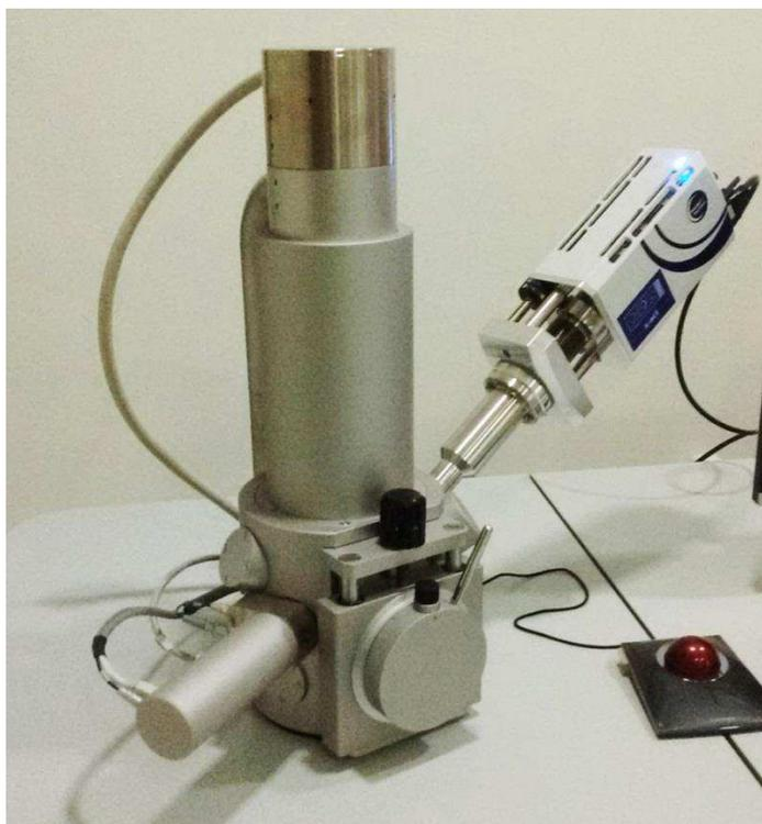
Figura 42 - Microscópio Eletrônico de Varredura (MEV) usado no Lammea (UFMG)
