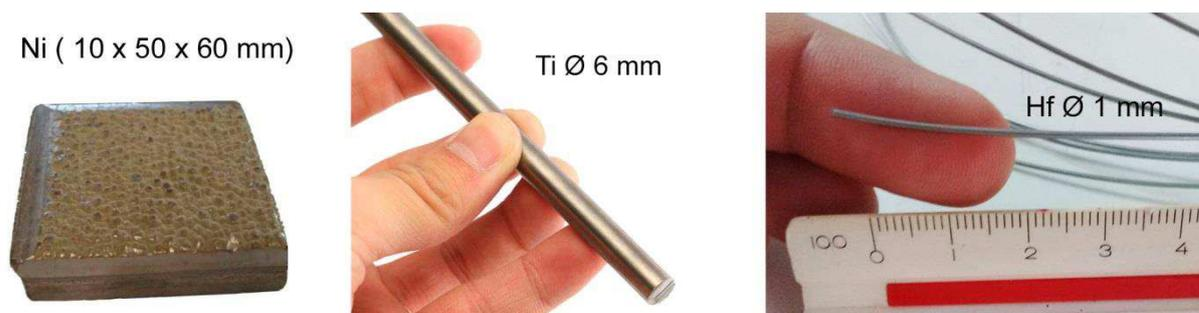
Figura 22 - Formas diversificadas dos elementos usados para obtenção das ligas
