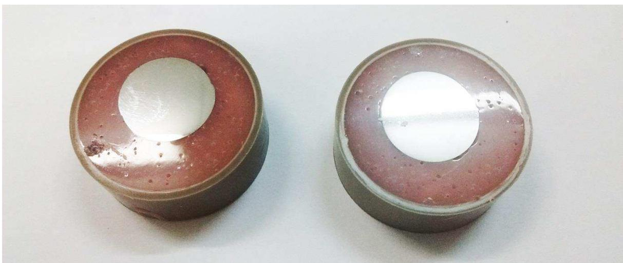
Figura 39 – Exemplos de corpos de prova atacados das ligas  $Ni_{50}Ti_{50-x}Hf_x$  .at%, obtidas por fusão à plasma, embutidos a frio com resina acrílica VIPIFlash em tubos de PVC
