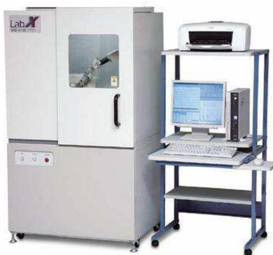
Figura 36 - Difratômetro *Shimadzu* XRD-6000 e sistema de aquisição de dados (LCM)
