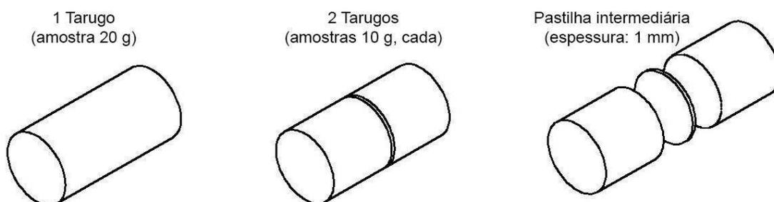
Figura 28 - Ligas  $\text{Ni}_{50}\text{Ti}_{50-x}\text{Hf}_x \text{ .at\%}$  (massa de cada amostra: 20 g):  $\varnothing 1 \text{ cm}$ ; altura: 2 cm
