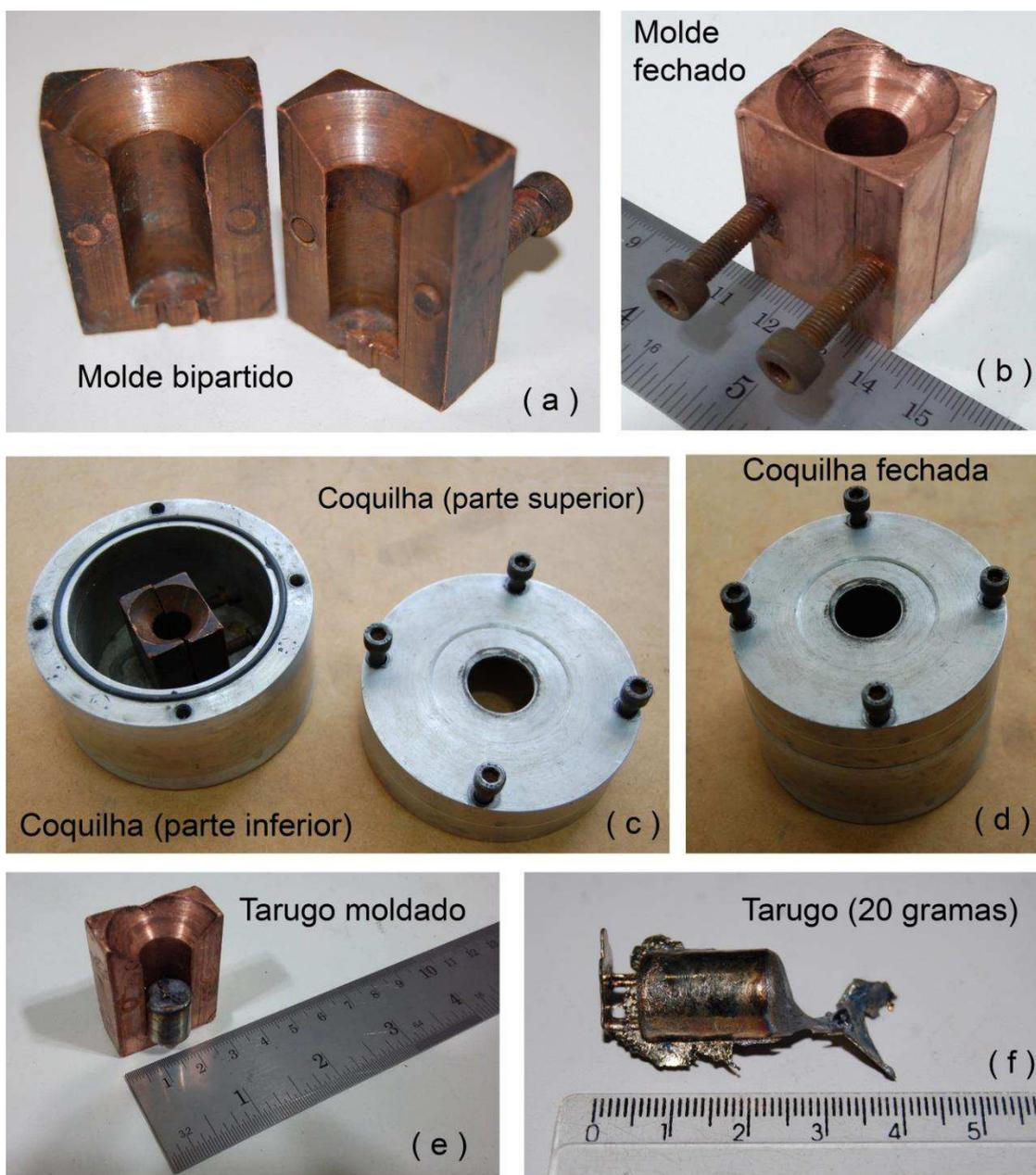
Figura 26 - Molde, coquilha e resultado da moldagem após fundição na *Discovery All*
