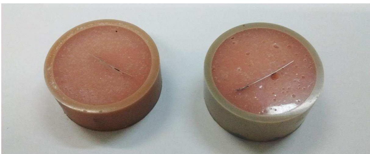
Figura 40 - Exemplos de corpos de prova atacados das fitas  $Ni_{50}Ti_{50-x}Hf_x$  .at%, obtidas por *melt spinning* e embutidas a frio com polímero vermelho em PVC: posição vertical
