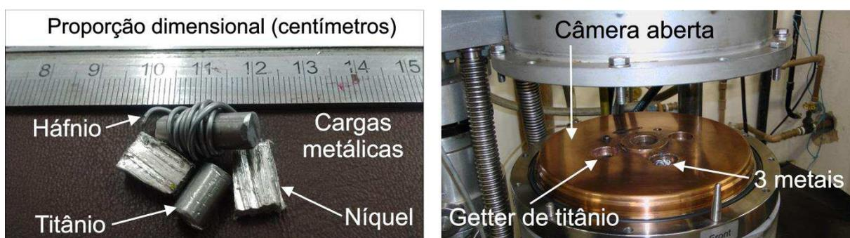
Figura 30 – Organização/disposição estratégica dos metais colocados no forno de fundição
