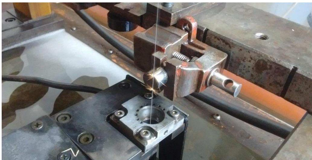
Figura 29 - Tarugos cortados em processo eletrolítico por um fio de tungstênio em faíscas
