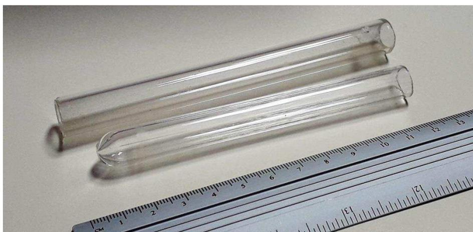
Figura 4 – Cadinho transparente ( $\varnothing$  cilíndrico: 1 cm) de quartzo usado no processo *Melt Spinning*, semelhante ao que foi usado nos experimentos laboratoriais deste trabalho
