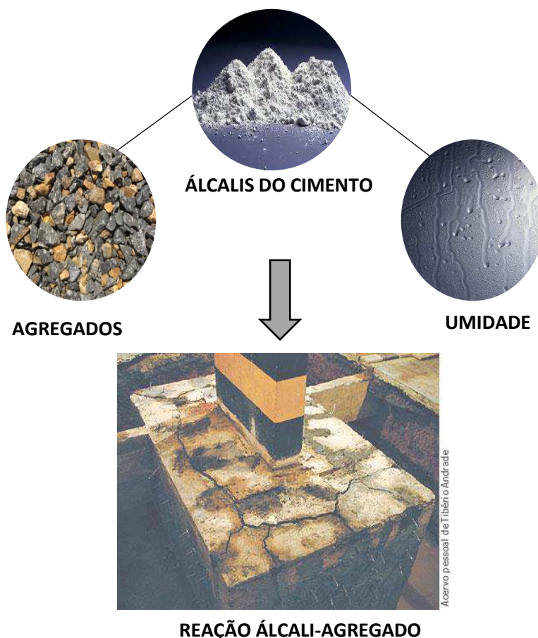
Figura 10: Fatores necessários para que ocorra a reação álcali-agregado. Ocorrência da reação na fundação de um pilar (imagem cedida pelo autor Tibério Andrade).
