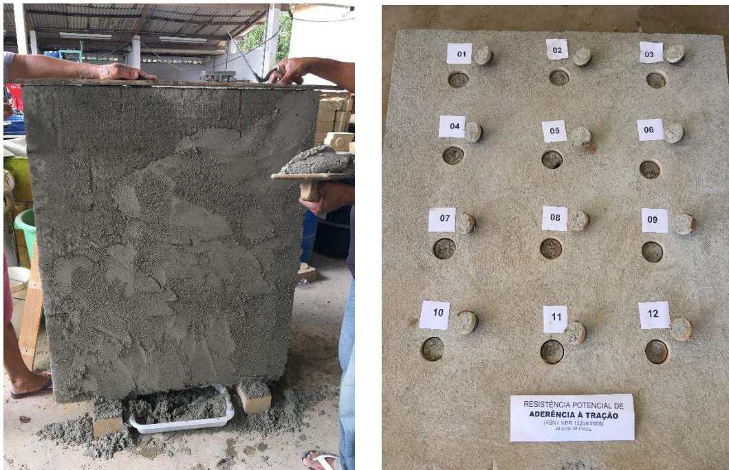
Figura 40: Alvenaria utilizada para ensaio de potencial de aderência à tração.
