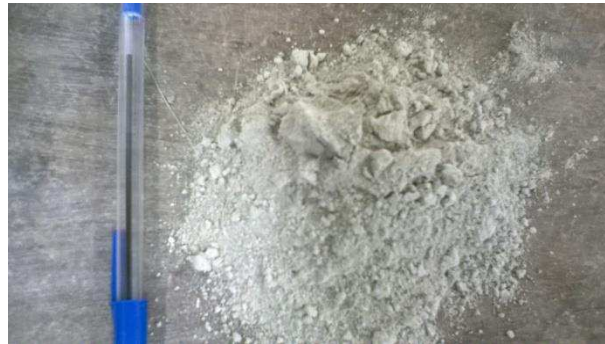
Figura 23: Resíduo de Scheelita após o processo de moagem.
