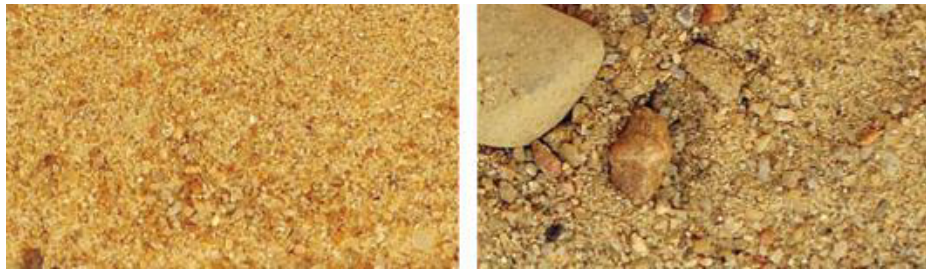
Figura 8: Exemplos de agregados naturais: areia fina (a esquerda) e areia média (a direita) (Modro et al, 2009).
