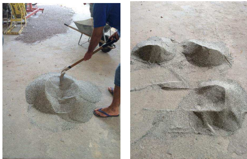
Figura 19: Processo de quarteamento da amostra.
