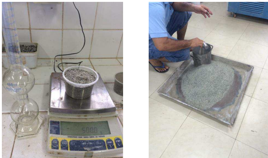
Figura 20: Equipamentos utilizados para ensaio de massa específica (esquerda) e massa unitária (direita).
