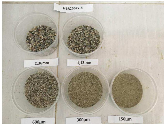
Figura 45: Frações do resíduo com diferentes granulometrias para o ensaio de expansão de barras.
