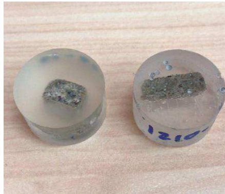
Figura 21: Amostras da argamassa produzida após o processo de embutimento.
