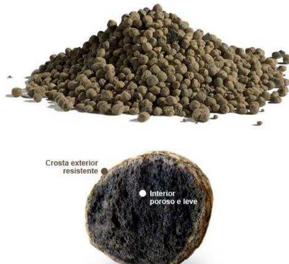
Figura 7: Exemplos de agregado leve; argila expandida (argex.pt).
