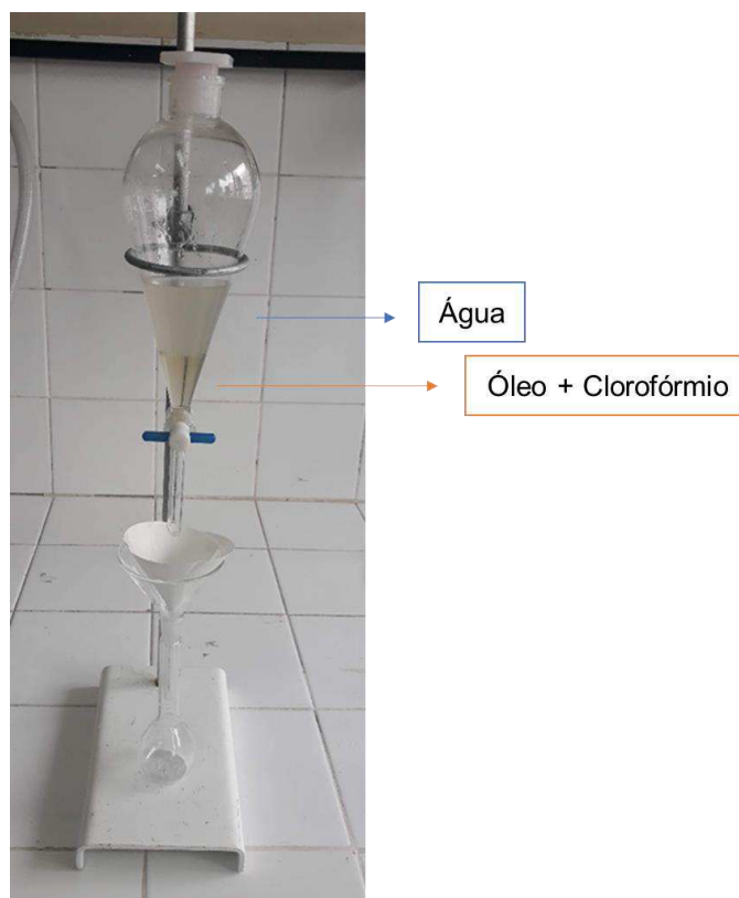
Figura 14 – Separação do óleo coletado, funil com duas fases: fase superior, cor clara, contendo água coletada; e fase inferior, coloração mais escura, contendo óleo + clorofórmio.
