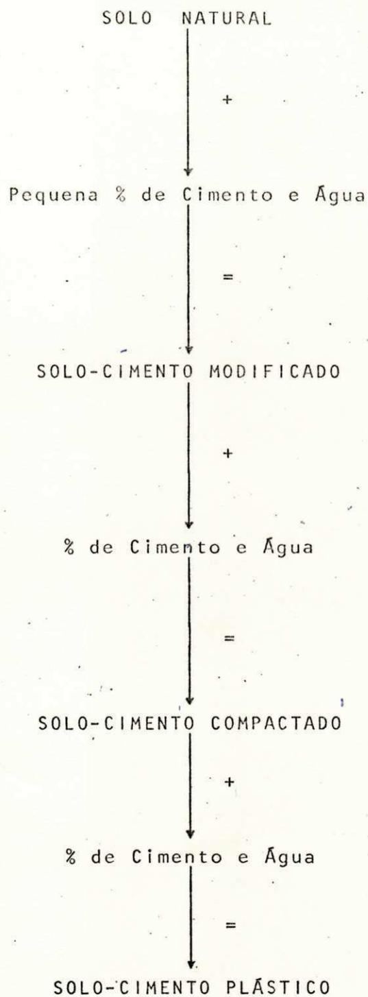
Fig. 2.1 - Fluxograma evolutivo das misturas solo-cimento a partir de um solo natural (CABRERA, 1974)
