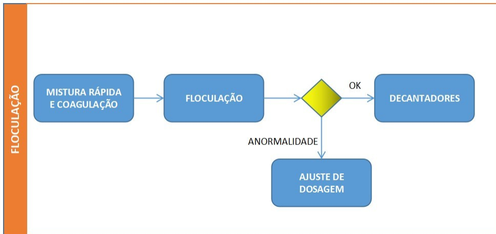
Figura 30 – Fluxograma de Floculação
