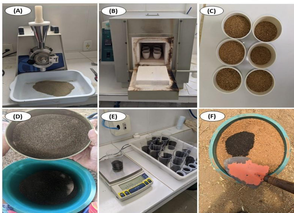
Figura 1. Moagem do resíduo de vermiculita (A), aquecimento do material em forno mufla (B), RV expandido após ser submetido a altas temperaturas (C), peneiramento do esterco bovino e mistura dos componentes (D), pesagem do fertilizante de acordo com os tratamentos (E), aplicação dos tratamentos em vaso (F).
