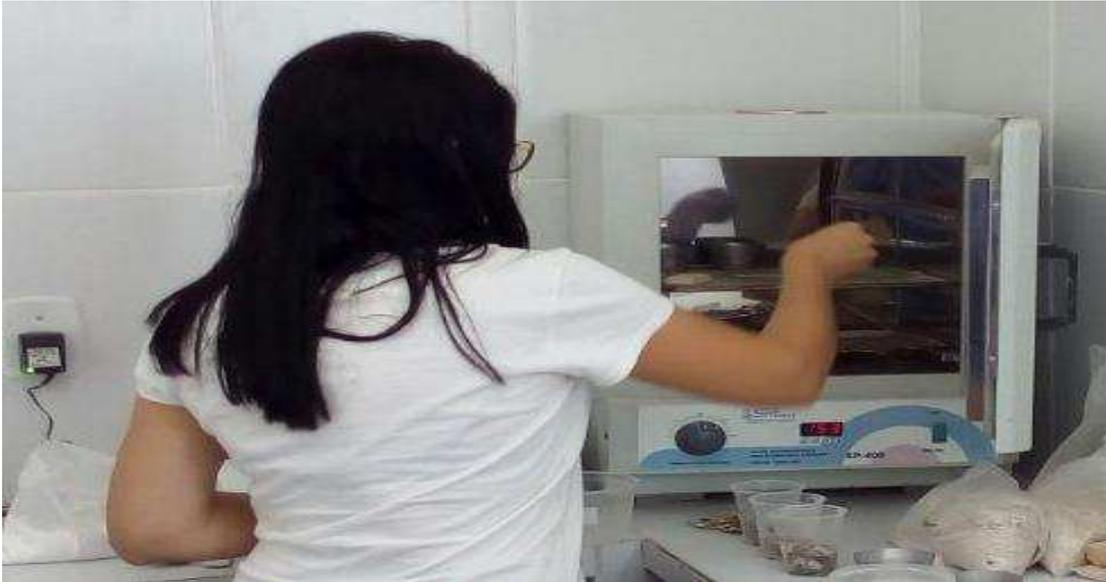
Figura 18 – Amostra em estufa para secagem.
