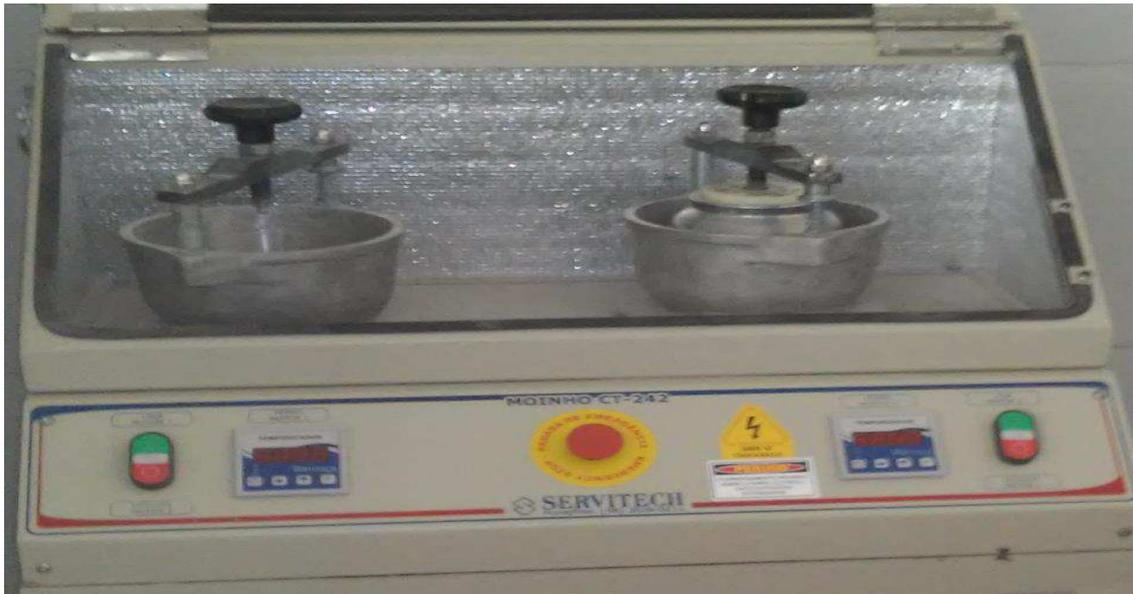
Figura 15 – Pulverizador usado na preparação de material para análise química.
