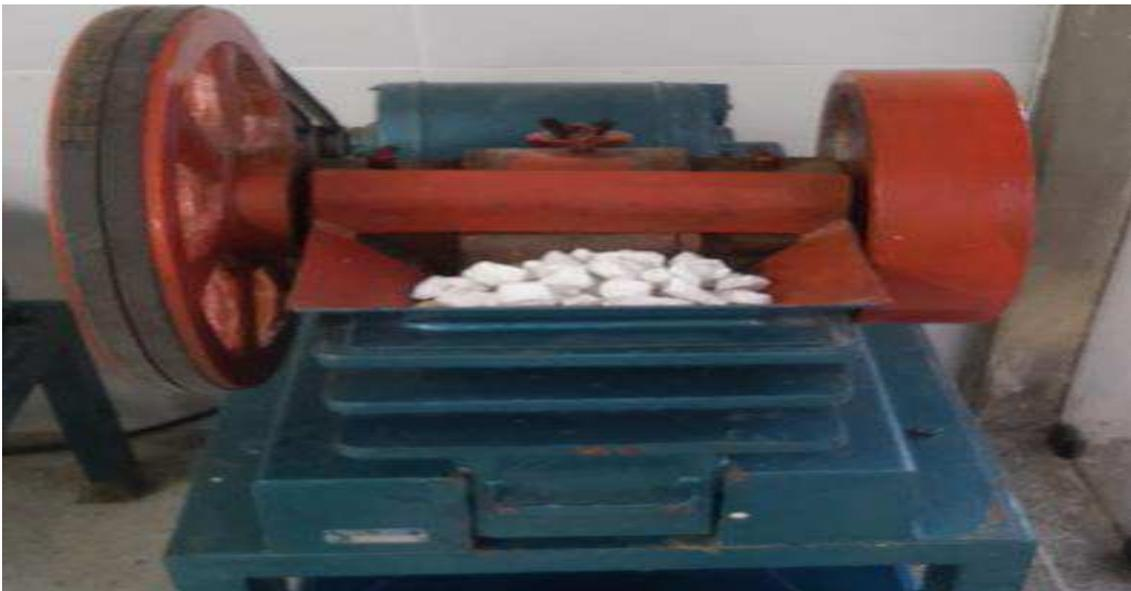
Figura 29 – Britagem secundária efetuada em britador de mandíbulas.
