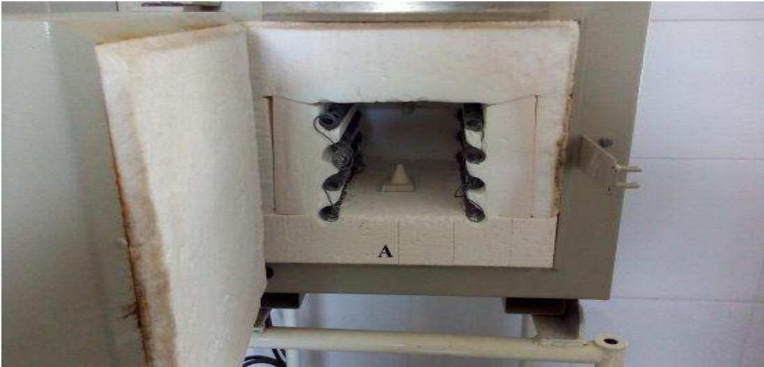
Figura 22 – Cone no Forno Mufla.
