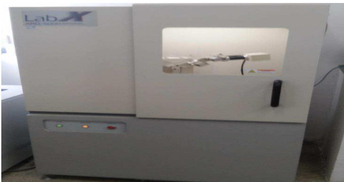
Figura 26 – Difratorômetro de Raios-X.
