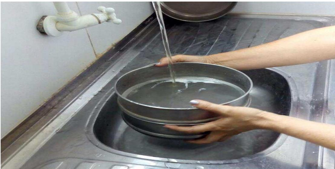
Figura 17 – Peneiramento sob água corrente.
