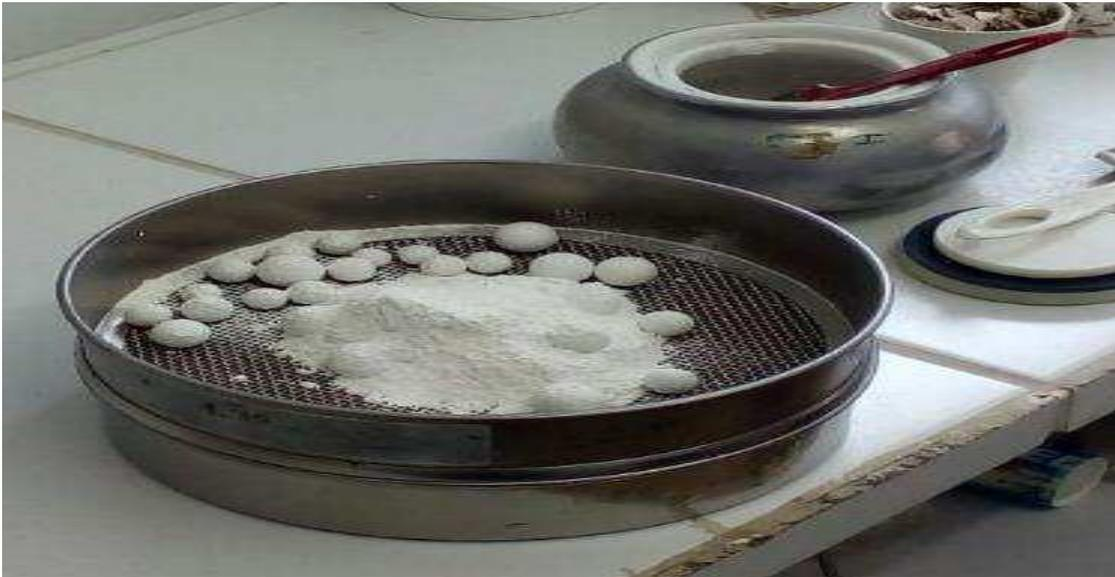
Figura 16 – Material após moagem para peneiramento.
