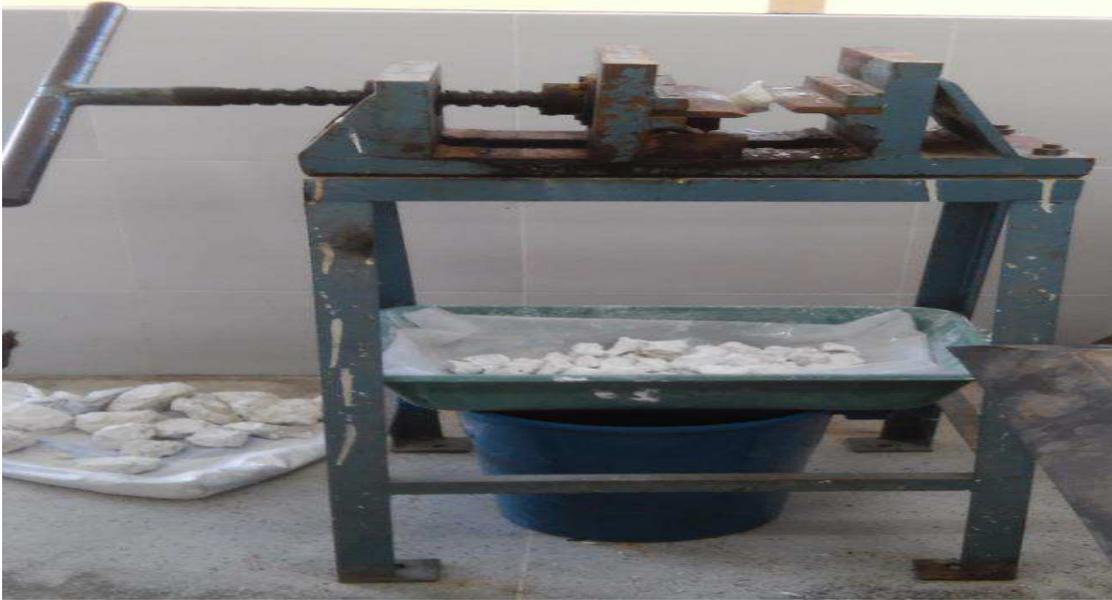
Figura 28 – Fragmentação primária em um equipamento de corte.
