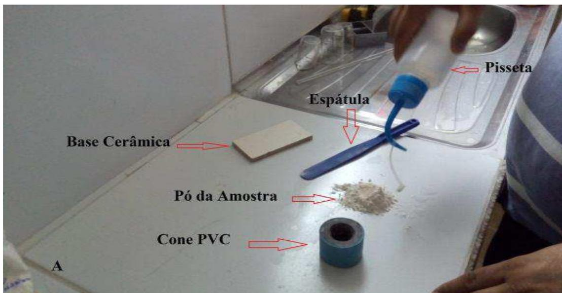
Figura 21 – Molde do cone e acessórios.
