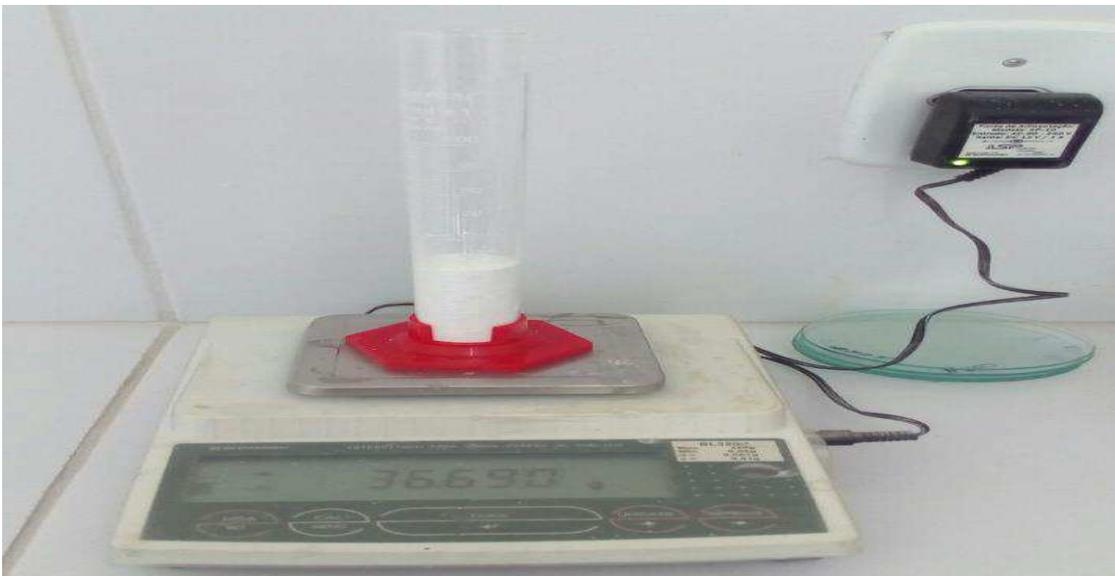
Figura 19 – Amostra em proveta.
