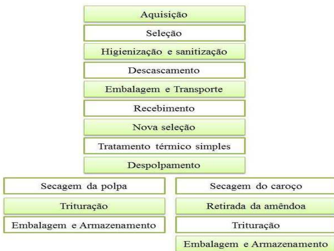
Figura 3 – Fluxograma da obtenção da polpa e amêndoa do pequi
